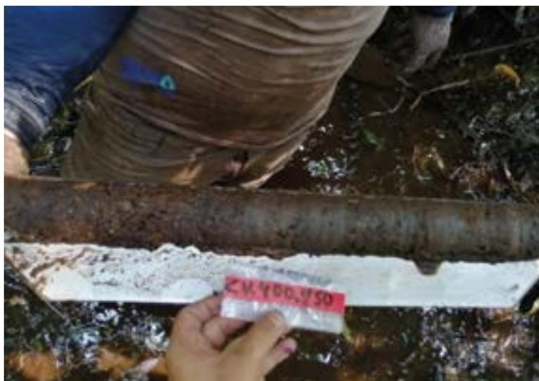
Foto 6. Medición de profundidad y colecta de muestra de turba
